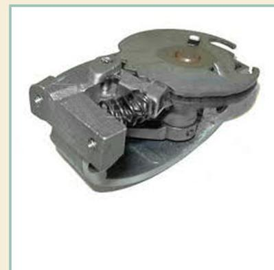
**Cod. 610370M** Selettore cambio Vespa PX (1978) / Gearbox selector Vespa PX (1978)
